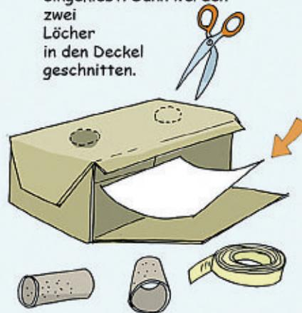
**2.** Die beiden Papprollen werden in die Löcher gesteckt und von allen Seiten mit Klebeband abgedichtet. Auch alle Ritzen am Karton werden mit dem Klebeband lichtdicht verschlossen.
