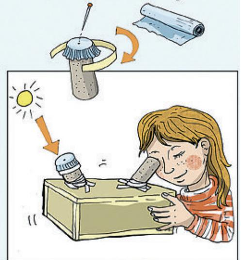
Richte nun die beiden Papprollen so aus, dass du den Sonnenstrahl auf dem Papier siehst. Fertig ist die Camera obscura. Durch das Loch fällt das Licht der Sonne in die Kiste und bildet auf dem Boden eine Kreisform. Damit kann man die Sonne prima beobachten!
